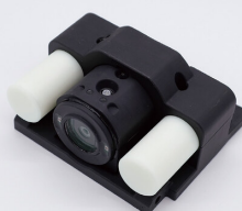
ハイドロフォン 2 個とマウントを組んだ例。マウントは装着面にあわせて製作します。
